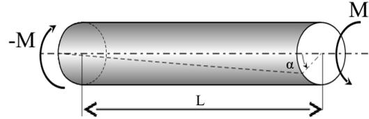
Le moment  $M$  est appelé *moment de torsion*, et est noté  $M_t$ .  $\alpha$  est l'angle de rotation entre les deux extrémités de la poutre.
