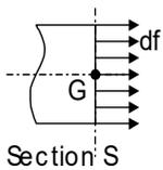
Chaque élément de surface  $dS$  supporte un effort de traction  $df$  parallèle à la ligne moyenne. Il y a répartition uniforme des contraintes dans la section droite. D'où :
