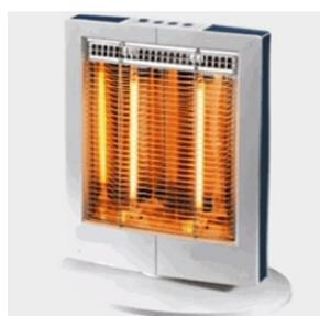
Le radiateur à halogène ou à quartz produit un rayonnement électrique Infrarouge Court (IRC) haute température, émis par un tube contenant un gaz halogène et un filament de tungstène porté à une température pouvant atteindre 2200 degrés.
