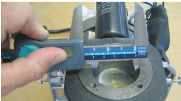
Mesure du diamètre du piston avec les becs du pied à coulisse.
